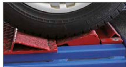
槽型后半边升起，进行底盘间隙检查
