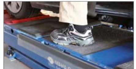
防滑颗粒物涂层表面，为顶车胶块提供防滑保护
