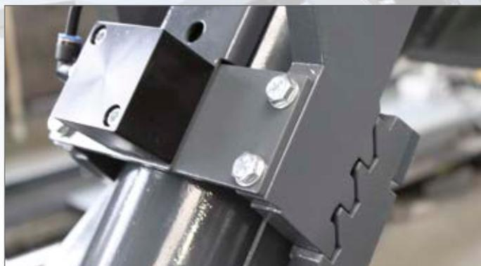
四轮定位举升机落锁功能使用的锁齿是切削加工的，确保每个齿的精度一致进而确保每个落锁高度测量精度一致
