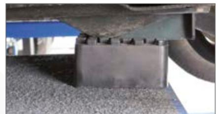
即使板上剪安装在配有高度补偿板的设备上，也可以在板上剪落到底时伸缩支撑板
